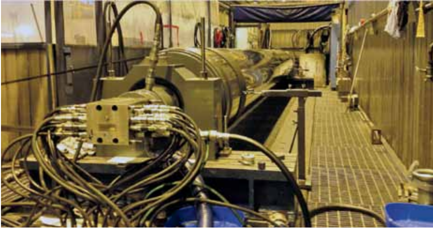
Karhula-Prüfstand zum Testen aller Arten von Biegeausgleichswalzen und Saugwalzen
