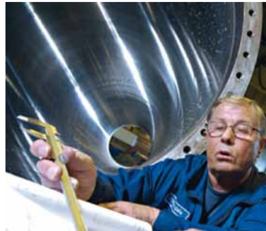
Als Service – nachgehonter Nipcowalzenmantel, Oberfläche Rauigkeit Ra = 0,4 µ
