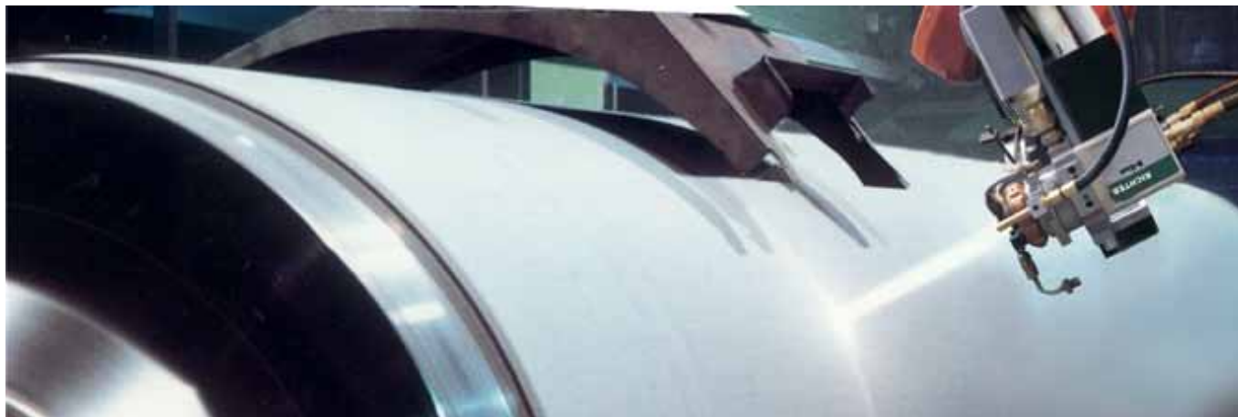
RiWaMat -Keramikbeschichtung einer Zentralwalze mit Plasma-Verfahren
