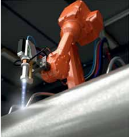
RiWaMat-Wolframkarbidbeschichtung einer Kalanderswalze mit HVOF-Verfahren
