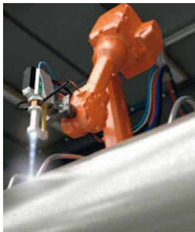
Wolframbid-Walzenbeschichtung einer Kalandrierwalze mittels HVOF-Verfahren
