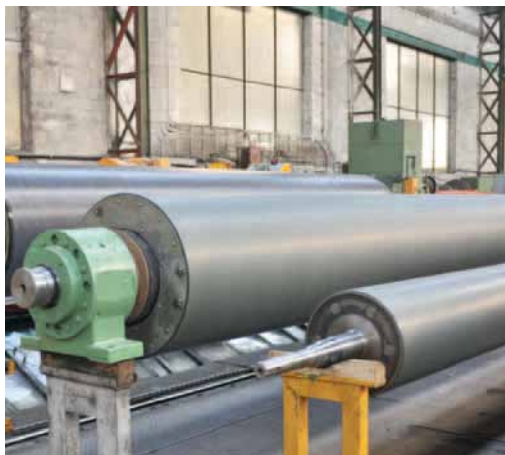
Keramische, beschichtete Siebantriebswalze und Siebleitwalze aus der Nasspartie einer Kartonmaschine
