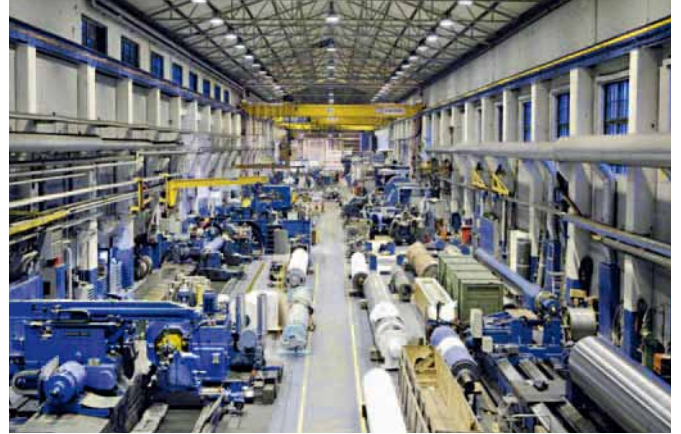
Hallenschiff für die Großwalzenbearbeitung wie drehen, schleifen, Rohre bohren, hohlen und wuchten. Dabei sind Stückgewichte bis 80 t möglich.
