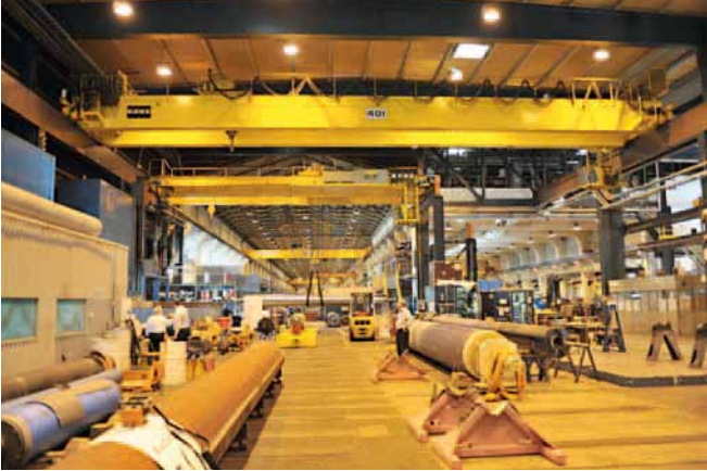
Die Fertigung besteht aus vier Hallenschiffen. Jedes Schiff ist fertigungstechnisch für bestimmte Walzentypen und Walzengrößen optimiert.
