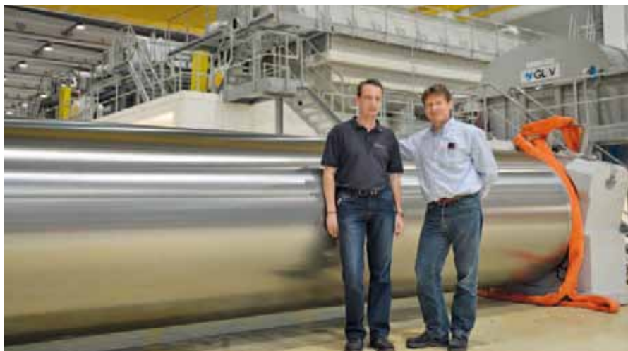
Ansicht des mit Hartmetall beschichteten G-Covers von UPM Hürth
