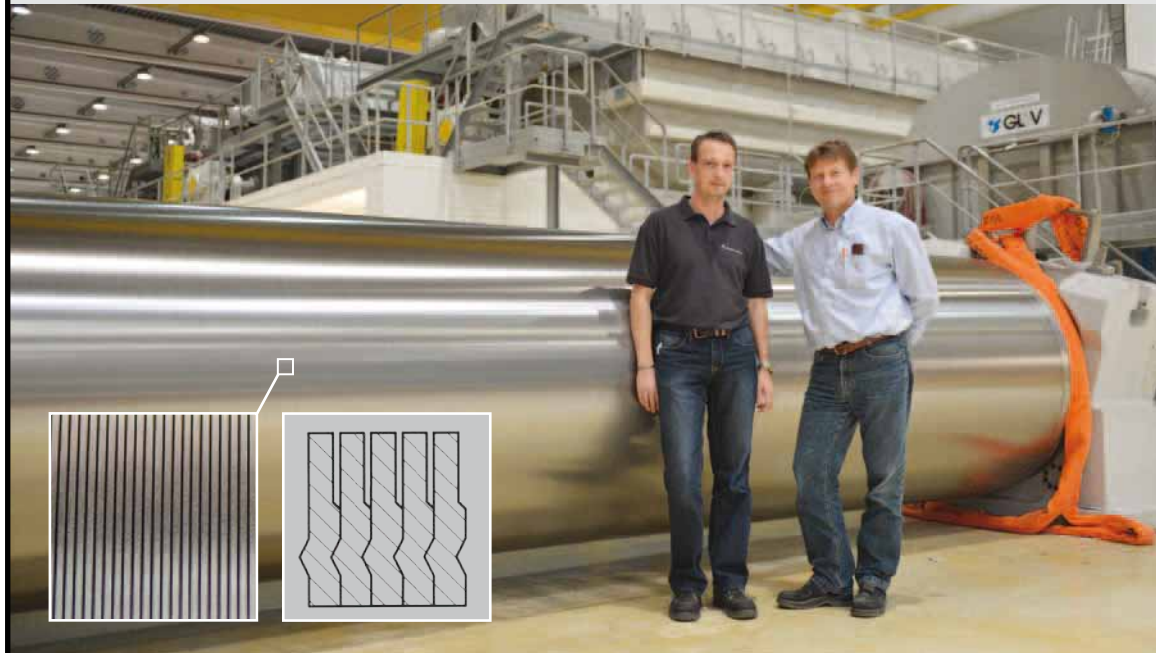
Nipcowalze von UPM Hürth, bezogen mit neuem G-Groove Bezug (Karhula produziert G-Cover seit 1988)
