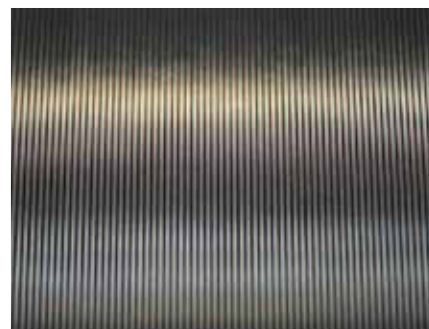
Ansicht des mit Hartmetall beschichteten G-Covers von UPM Hürth
