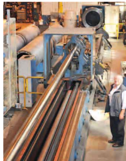
Wolfgang Richter an der Honmaschine in Karhula ø 1,70 m x 10,50 m Länge (60 t)
