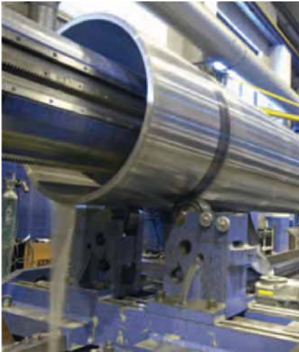
Ausbohren eines Rohres zur Fertigung eines neuen Biegeausgleichswalzenmantels
