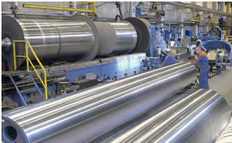
Großwalzendreherei im Werk Karhula in Finnland für max. Bauteilgrößen x 2,10 m x 18 m Länge (80 t)
