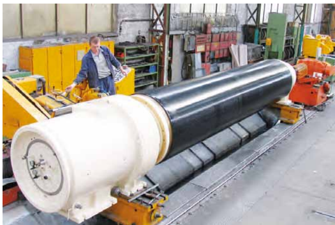
Schleifen einer im Werk II Rolls generalüberholten Saugwalze
