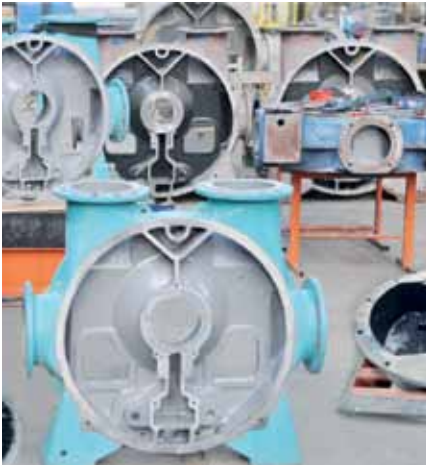
Seitenschilder beschichtet mit den jeweiligen Einsatzbedingungen angepassten Composites
