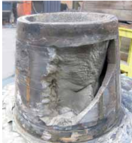
Verstopfter Nash Konus, die Vorort-Analyse ergab einen Kapazitätsverlust von 85 %
