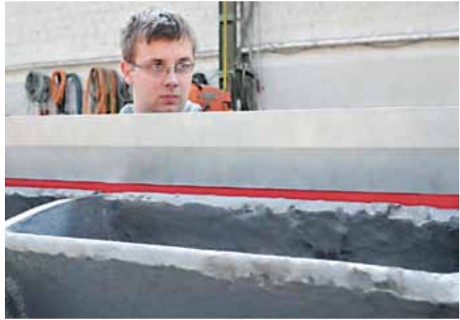
Verschlossener Vakuumpumpenläufer Siemens-Elmo nach dem Sandstrahlen, der Materialverlust des Läufers ist rot markiert.
