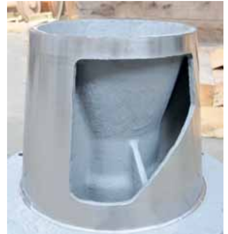
Gereinigter und mit Composites gegen erneute Ablagerungen beschichteter Nash Konus
