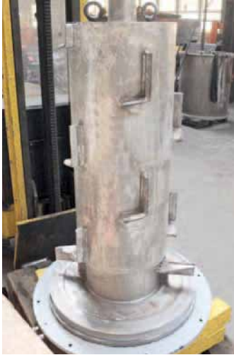
Trommelrotor CS12 (siehe Titelseite) hochverschleißfest aufgearbeitet
