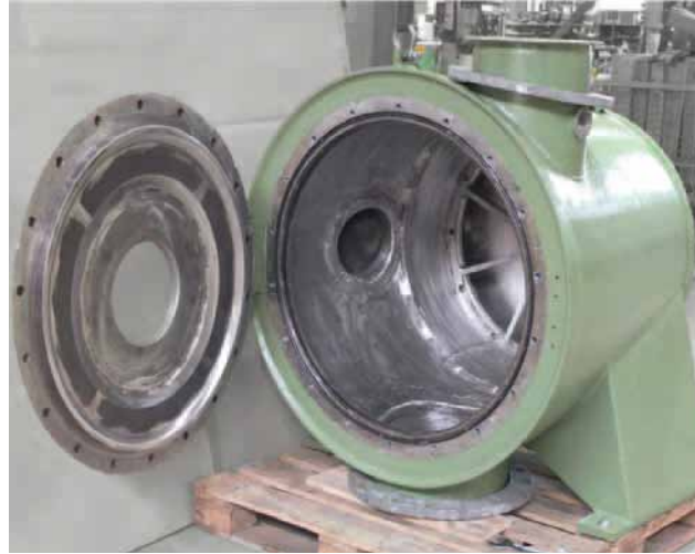
Auf CNC -Bohrwerk fertig bearbeitetes hochverschleißfest regeneriertes Fiberizer Gehäuse F1T
