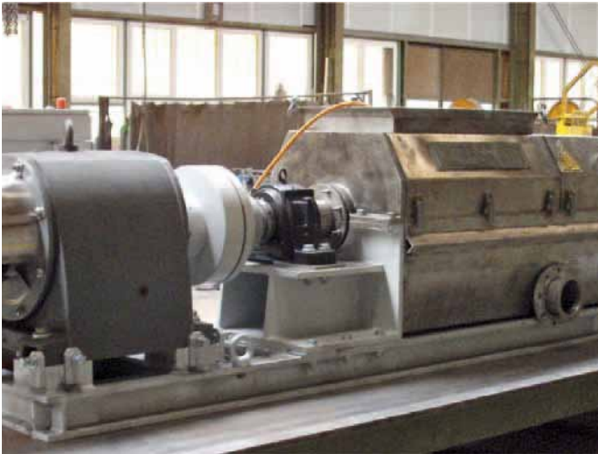
Generalüberholung Kufferath Presse A500 mit hochverschleißfest aufgearbeiteten Bauteilen ( inkl. Elektrik und Pneumatik)
