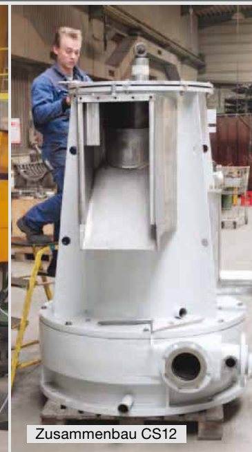
Bearbeitung neues „verschleißfestes“ Gehäuse-Oberteil Combisorter CS12
