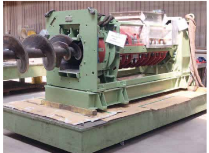
Generalüberholung einer Beltec Presse BP601 mit hochverschleißfest aufgearbeiteten Bauteile.
