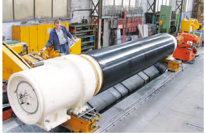
II-tehtaalla Rolls kunnostetun imutelan hionta
