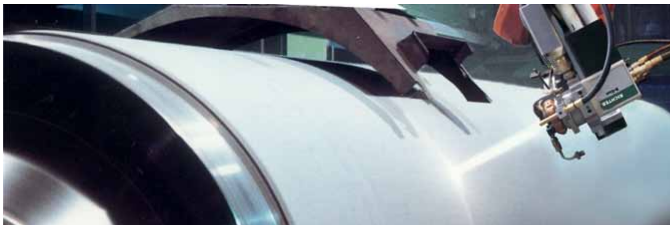
RiWaMat –keramische walsbekleding via een plasma-proces
