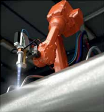
RiWaMat-wolframcarbide bekleding van een kalenderwals met het HVOF-proces
