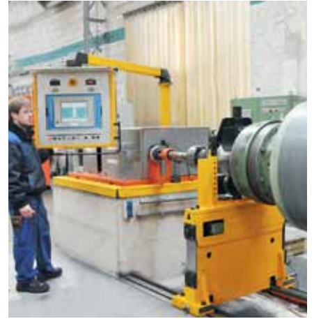
Centrale perswals met een plasma-keramische bekleding op de balanceerbank
