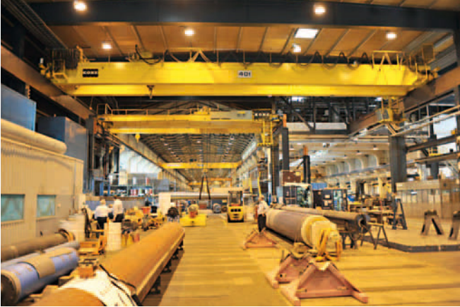
De fabricage vindt in vier secties van de fabriekshal plaats. Iedere sectie is vanuit productietechnisch oogpunt geoptimaliseerd voor bepaalde typen walsen en walsafmetingen.
