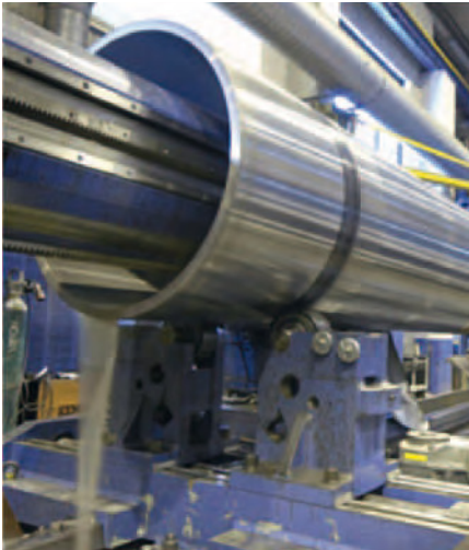
Uitboren van een buis voor een nieuwe buiging compenserende- walsbehuizing
