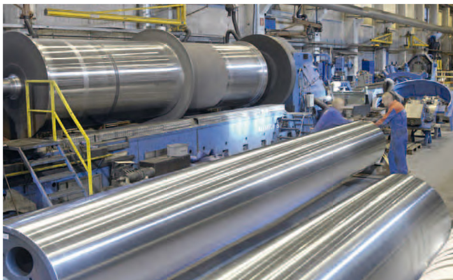
Draaibank voor grote walsen in de fabriek Karhula in Finland voor max. werkstuk afmetingen Ø 2,10 m x 18 m lengte (80 t)
