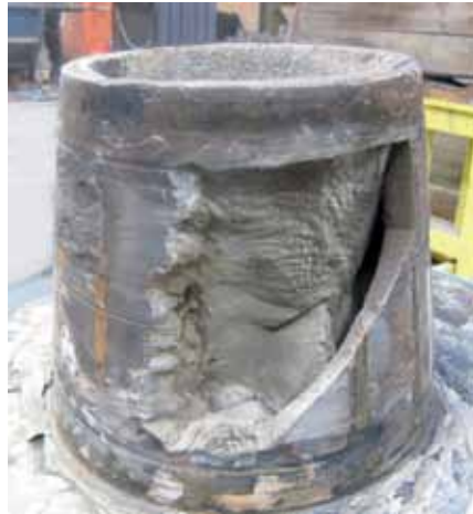
Verstopte Nash-conus. Uit de analyse op locatie bleek een 85% vermogensverlies
