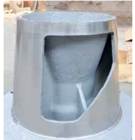
Gereinigde Nash-conus die met composiet bekleding beschermd is tegen nieuwe afzetting
