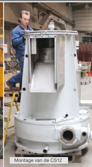
Bewerking van een nieuw "slijtvast" bovendee van de behuizing van combisorter CS12
