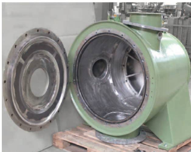
Op CNC-gestuurde boormachine bewerkte ultraslijtvast geregenereerde behuizing FT
