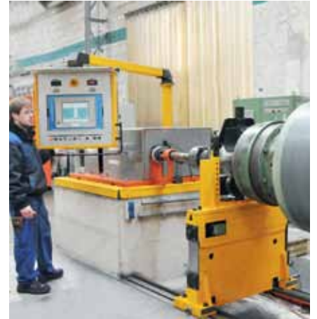
Centralvals med plasmakeramik på balanseringsmaskin
