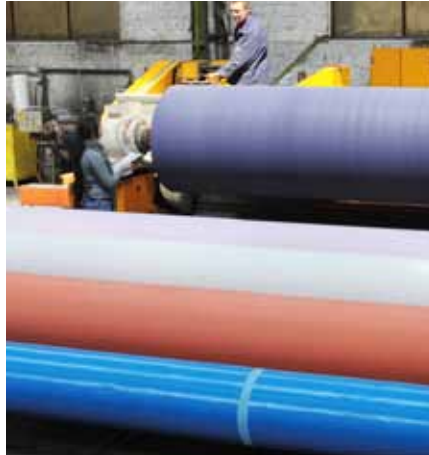
RiWaMat-kompositkeramik-belag på slipmaskin
