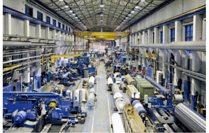
Hallen för bearbetning av stora valsar där man utför arbeten som svarvning, slipning, borrar, hening och balansering. Här är det möjligt att bearbeta styckvikter upp till 80 ton.
