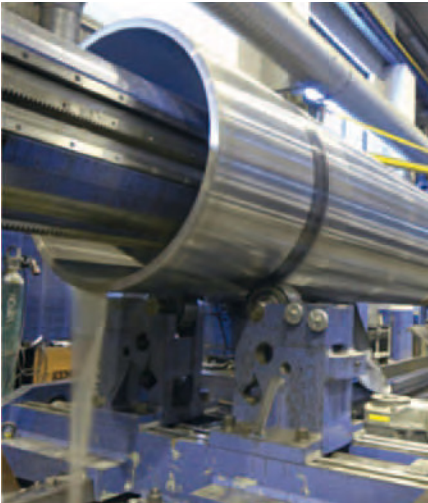
Intern mantelsvarvning för en böjningskompenserande vals
