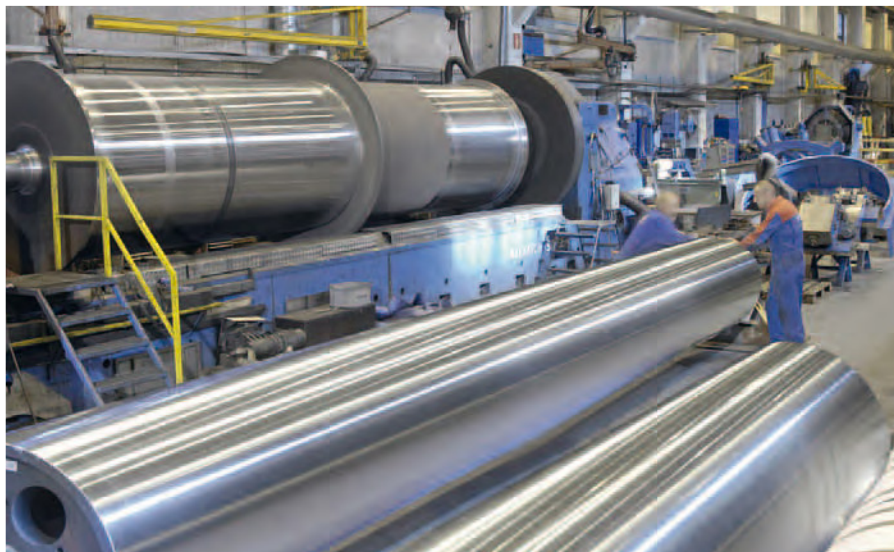
Storvalsvarvning i Karhula, Finland för storlekar upp till en diameter på 2,10m x 18m längd (80t)
