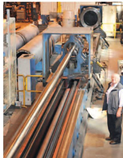
Wolfgang Richter vid slipmaskinen i Karhula dia. 1,70m x 10,50m (60t)
