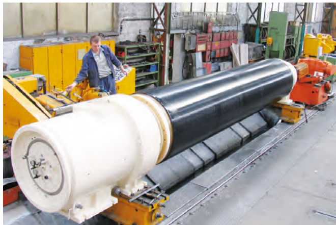
Slipning vid renovering av en sugvals i Verk Rolls
