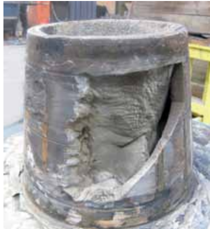
Igensatt Nash-kon, på-plats-analysen visade en kapacitetsförlust på 85%
