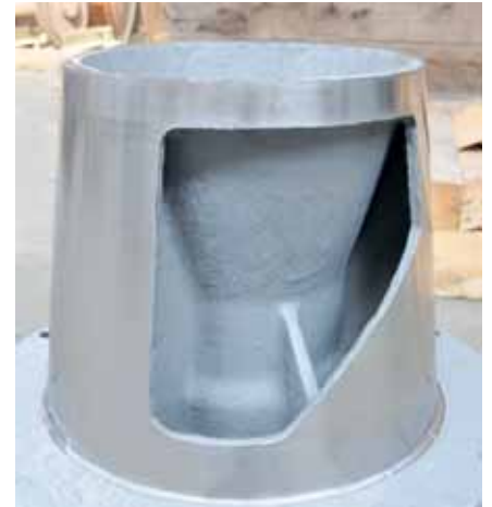
Återställd Nash-kon som kompositbelagts för att undvika framtida avlagringar
