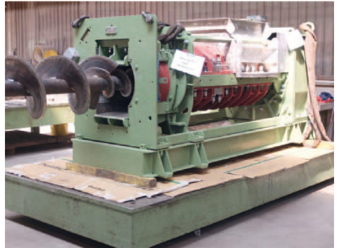
Översyn av en Beltec Press BP601 med slittålig komponentbearbetning
