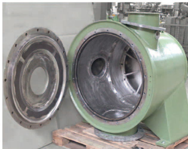
Med CNC-borr svarvas och bearbetas höljet för Fiberizer F1T för hög slitstyrka
