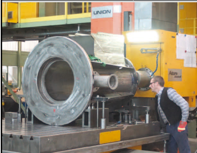
Bearbetning av det nya „slitstarka“ ytterhöljet på Combisorter CS12
