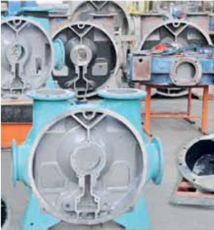
Placas laterales recubiertas con los compuestos ajustados según las condiciones de uso
